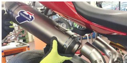
**ITA** Inserire silenziatore destro (7) e avvitarlo alla staffa supporto silenziatori(18) tramite vite (12) e rondella (25) in dotazione.
