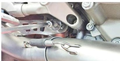
**ITA** Fissare la staffa con vite (10) e rondella (24) in dotazione.
