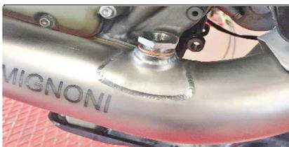
**ITA** Inserire riduzione sonda (27) con rondella (22) e avvitare
