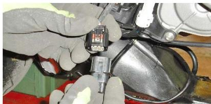
**ITA** Innestare il cappuccio di protezione (17), in dotazione
