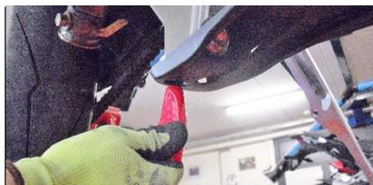
**ITA** Fissare carter inferiore con la vite di serie
