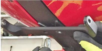
**ITA** Montare staffa supporto silenziatori (18) con viti (11) e rondelle (23) in dotazione e serrare
