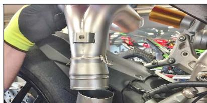
**ITA** Inserire corpo finale (6) nel collettore e agganciare i due particolare con le molle usando il tira molle (15) in dotazione
