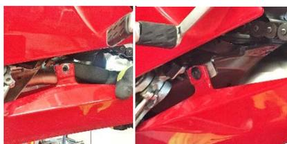
**ITA** NEL CASO SI HANNO LE SOTTOCARENE DELLA PANIGALE 959, FISSARE LA CARENA SINISTRA ALLA STAFFA (19) TRAMITE VITE (13), RONDELLA (21) E DISTANZIALE (37) IN DOTAZIONE.
