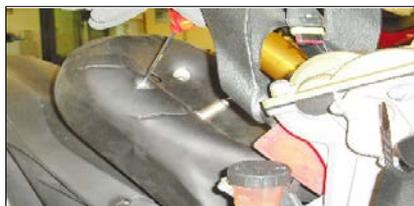
**ITA** Rimuovere il paracalore posteriore svitando le viti di fissaggio
