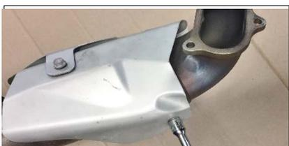
**ITA** Rimuovere i paracalori attacco testa anteriore e tenerli per il montaggio del kit Termignoni
