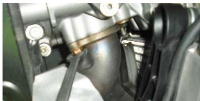
**ITA** Rimuovere attacco testa anteriore svitando i dadi di fissaggio e conservandoli per il montaggio del kit Termignoni.
