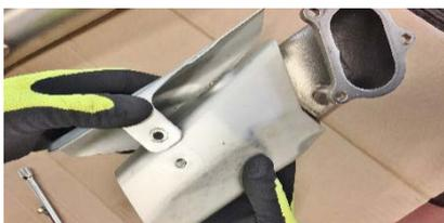
**ITA** Montare paracalore di serie sull'attacco testa anteriore e serrare con viti in dotazione (9)
