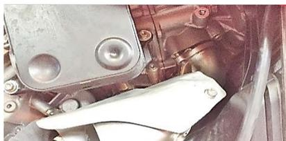
**ITA** Fissare l'attacco testa anteriore con i dadi originali, senza serrare
