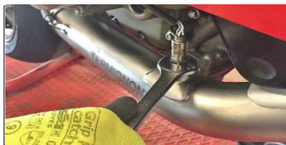
**ITA** Avvitare sonda lambda e serrare. Ripetere la stessa operazione per la sonda posteriore.
