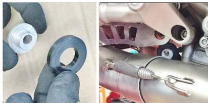
**ITA** Inserire distanziale(25) e silent block (36) nella parte posteriore della staffa supporto collettore
