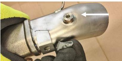
**ITA** Sull'attacco testa anteriore(1), avvitare tappino sonda (16) con rondella (26) dove indicato dalla freccia, e posizionare le mollette filettate M5(35) sulle staffe supporto paracalore .
