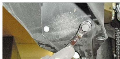
**ITA** Rimuovere il motorino della valvola svitando le 4 viti di supporto
