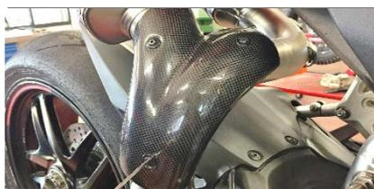
**ITA** Fissare i paracalore al corpo finale (6) con le viti in dotazione (13)
