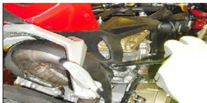
**ITA** Svitare le viti fissaggio codino al motore e sollevarlo tenendolo separato da quest'ultimo posizionando uno spessore
