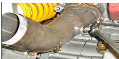
**ITA** Rimuovere attacco testa posteriore svitando i dadi di fissaggio e conservarli per il montaggio del kit Termignoni
