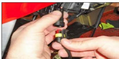
**ITA** Scollegare il connettore della ventola; una volta sfilato dall'involucro del motorino valvola, ricollegarlo
