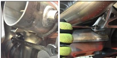
**ITA** Rimuovere fascetta innesto, vite e dado e tenerla per il montaggio del kit termignoni. Rimuovere dado e vite anteriori destro e sinistro di fissaggio pre-silenziatore e smollare vite fissaggio staffa supporto pre-silenziatore.
