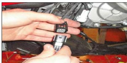
**ITA** Scollegare il connettore del motorino valvola e innestare il cappuccio di protezione, in dotazione
