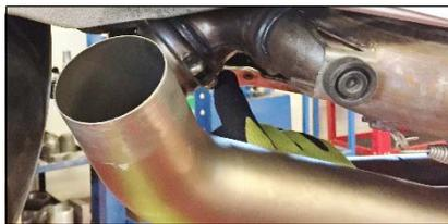
**ITA** Fissare il corpo centrale ai collettori di serie con la fascetta innesto, vite e dado di serie e serrare
