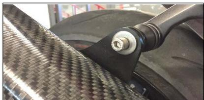
**ITA** Fissare la staffa di supporto al telaio della moto, usando il distanziale in alluminio nero, la vite, la rondella e il dado in dotazione.
