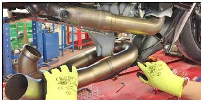
**ITA** Posizionare il corpo centrale decatalizzato spostando il carter
